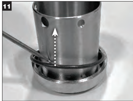
Rimuovere l'O-ring (W) dalla scanalatura dell'O-ring della bussola ed eliminarlo.
